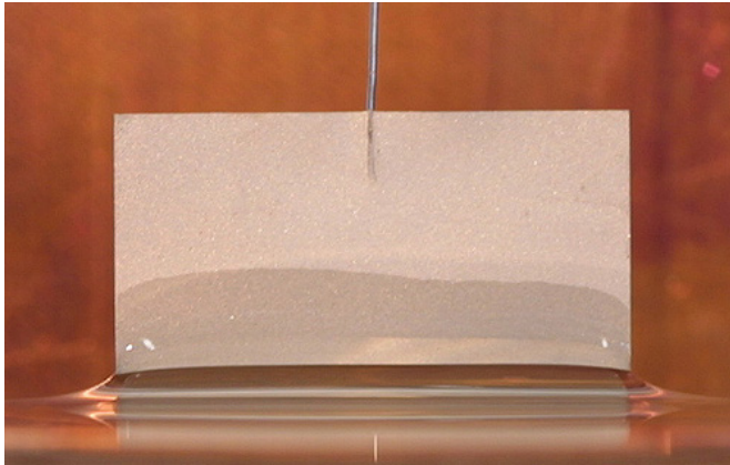
Bild 6: Wilhelmy - Plättchen Methode zur Bestimmung der Oberflächenspannung von Flüssigkeiten
