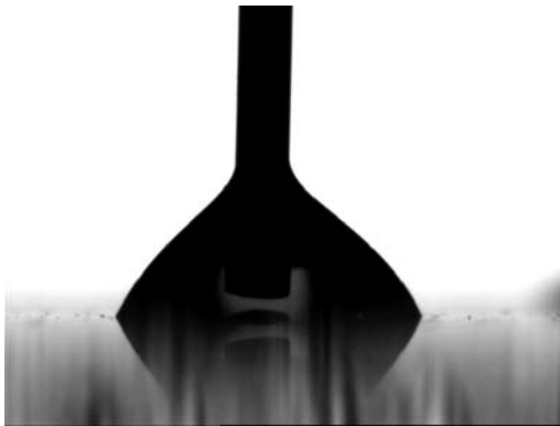
Bild 14: Absaugen eines Tropfens durch eine Kanüle zur dynamischen Messung des Rückzugwinkels
