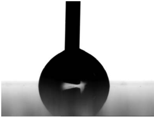
Bild 13: Aufbringen eines Tropfens durch eine Kanüle zur dynamischen Messung des Vorrückwinkels
